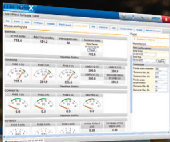
La télélecture de la consommation d'électricité, d'eau et de gaz
